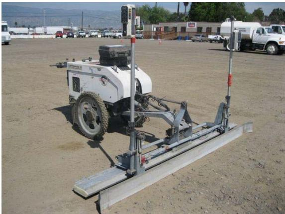
Figure 8: Nivelador Guiado por Laser
